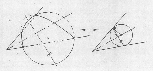
5.2 Genauso findet man: Schneiden sich zwei Zylinder so, daß die Zylinder symmetrisch zu einer Rißtafel liegen, so ist der Riß der Verschneidungskurve ein Teil einer Hyperbel, weil durch "Aufblasen" eines der Zylinder die linke Zeichnung in die rechte übergeht.
