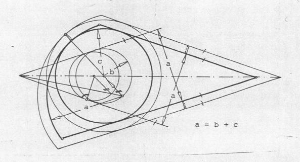
Zur Verdeutlichung des Aufblasvorganges wurde außen um das Dreieck ein Dreieck als Parallelkurve gezeichnet, mit dem ein elementargeometrischer Beweis gefunden werden kann.
