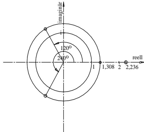
Im Einzelnen: Nebenstehend werden die dritten Wurzeln aus der reellen Zahl  $\sqrt{5} \approx 2,236$  untersucht. Die dritten Wurzeln liegen deshalb auf einem Kreis um den Ursprung mit Radius
